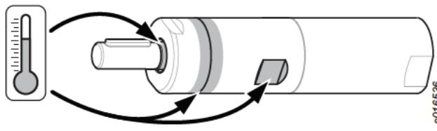
De følgende varmepunktene på motoren (slik som sett i figuren ovenfor) kan nå høye temperaturer i løpet av drift:
