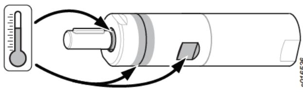
Seuraavat pisteet moottorissa (katso kuva yllä), voivat saavuttaa korkean lämpötilan käytön aikana.
