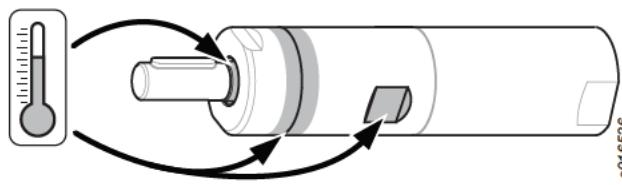
Les points chauds suivants sur le moteur (comme illustré sur la figure ci-dessus) peuvent atteindre des températures élevées en fonctionnement :
