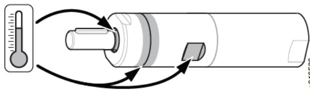
Os pontos de acesso no motor a seguir (como visto na figura acima) podem atingir temperaturas elevadas durante a operação:
