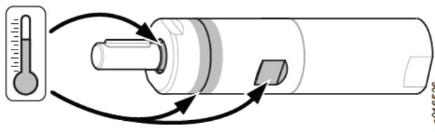
Følgende varmepunkter på motoren (som vist på ovenstående figur) kan nå høje temperaturer under drift:
