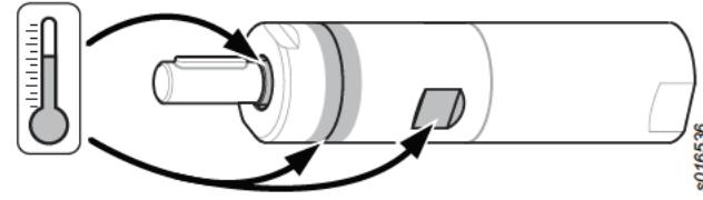
Следните горещи точки на мотора (както се вижда на фигурата) могат да достигнат висока температура по време на работа:
